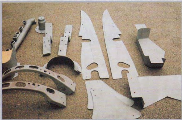
Ansammlung diverser Blechteile, oben links der Auspuffkrümmer, darunter die Stützstreben der Kotflügel
