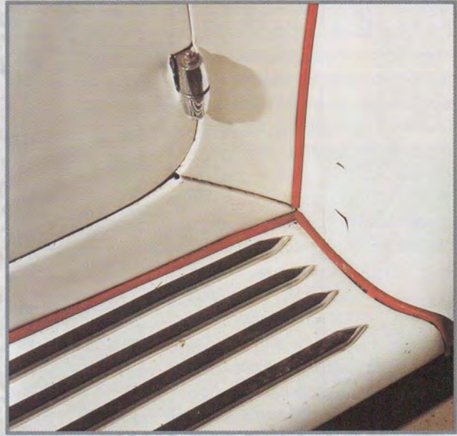
Hintere Türkante mit Scharnier und Trittbrett
