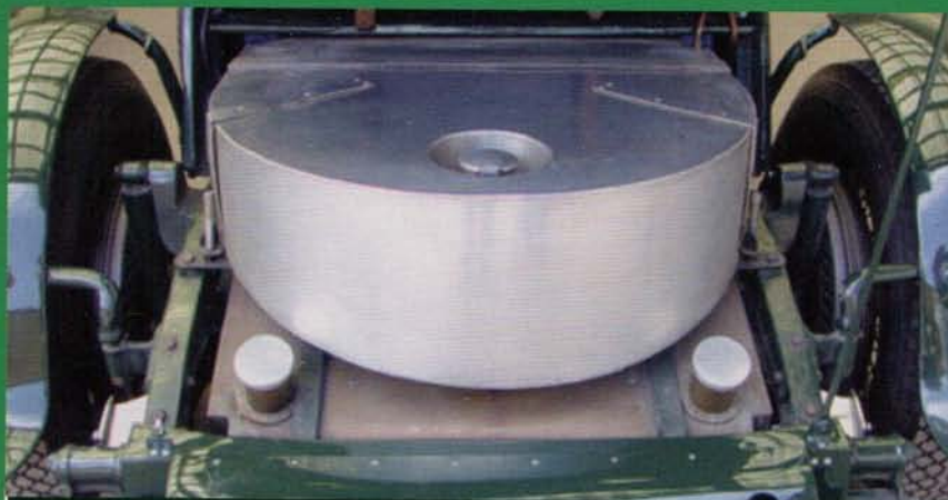
Das Beetle Back (nicht Boat Tail) macht Stromlinie – und hat es in sich: der Zusatztank wird dringend gebraucht, weil bei Vollgas kein Tankwagen schnell genug hinterherkommt.
