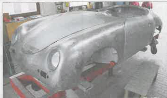
Bis dieser Porsche 356 wieder Vollgas geben kann, stehen ihm noch viele Behandlungsschritte in der Werkstatt bevor. Boden, Türen und viele andere Teile sind bereits ersetzt.
